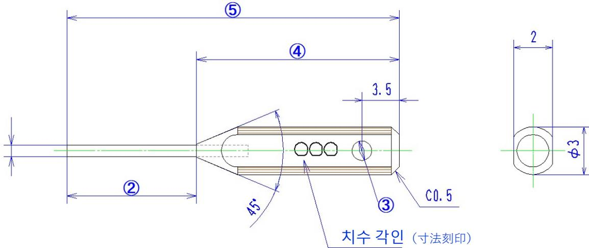
※ 이 사양은 핀직경  $\phi 0.5 \sim 1.0\text{mm}$ 의 홀더사양 핀게이지에 적용되는 견적양식입니다.
